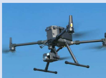
センサー付ドローンによる検査
